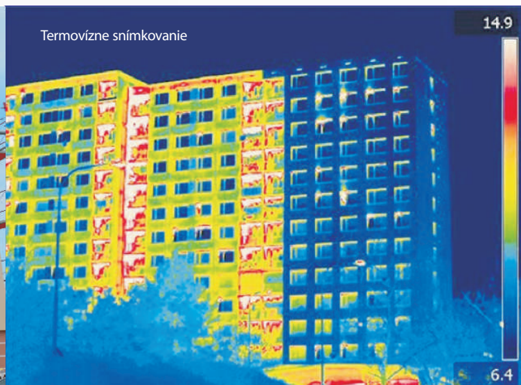
BD Ivánka pri Dunaji, hydroizolácia a zateplenie strechy, zateplenie obvodového plášťa
